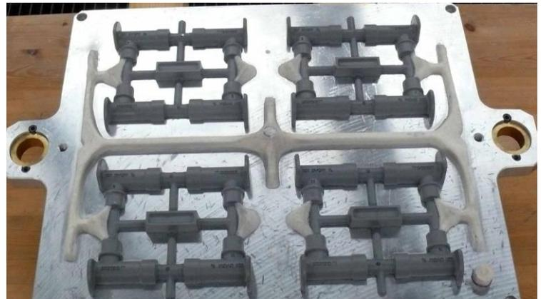
Gussform in Bearbeitung (links), Anstelle üblicher Trennmittel, mit **Langzeitanstrich RK CCS** beschichtete Gussformen. Die Keramikbeschichtung ist beständig gegen Temperatur, bei Metallguss.
