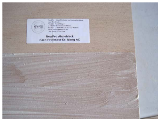
Abb.5 Schiffsplanke Kunststoff + Abziehlack nach Prof. Dr. Mang in trockenem Zustand
