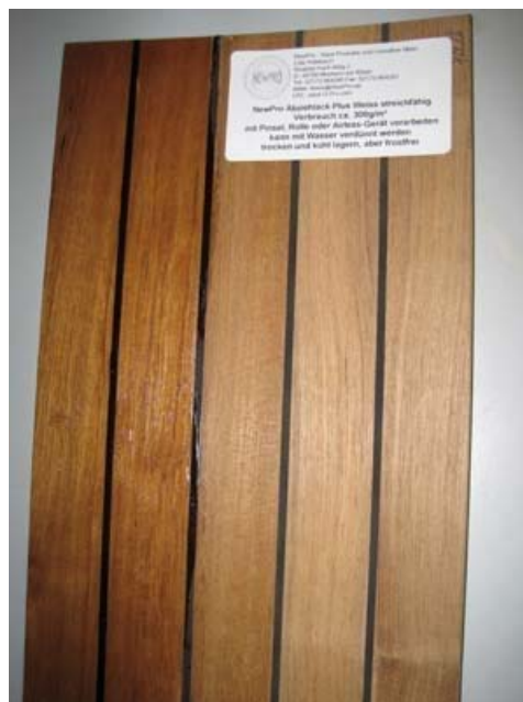
Abb.1 Schiffsplanke TEAK + Abziehlack plus in trockenem Zustand
