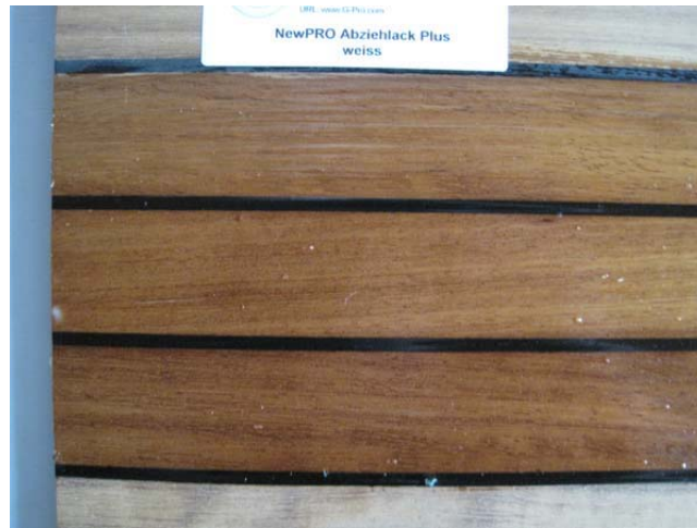
Abb.3 Schiffsplanke Troko + Abziehlack plus in angetrocknetem Zustand
