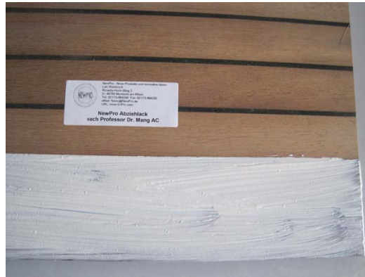
Abb.6 Schiffsplanke Troko + Abziehlack nach Prof. Dr. Mang in feuchtem Zustand
