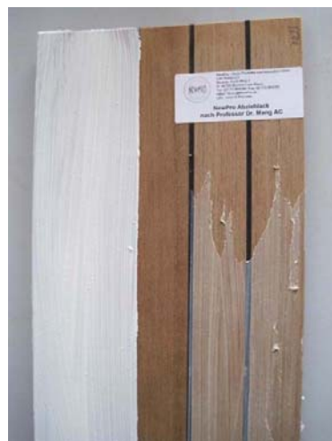
Abb.4 Schiffsplanke TEAK + Abziehlack nach Prof. Dr. Mang in angetrocknetem und feuchtem Zustand
