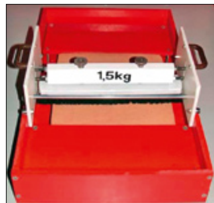
Abb. 2: An der BAM Berlin entwickeltes Reinigungsgerät für Standardproben im Labormaßstab
